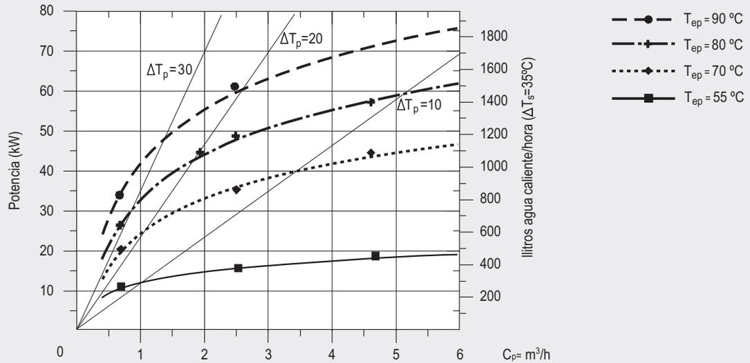
Curvas de potencia para diferentes caudales y temperaturas de circuito primario para producción de agua caliente (circuito cerrado) 10°C → 60°C.
