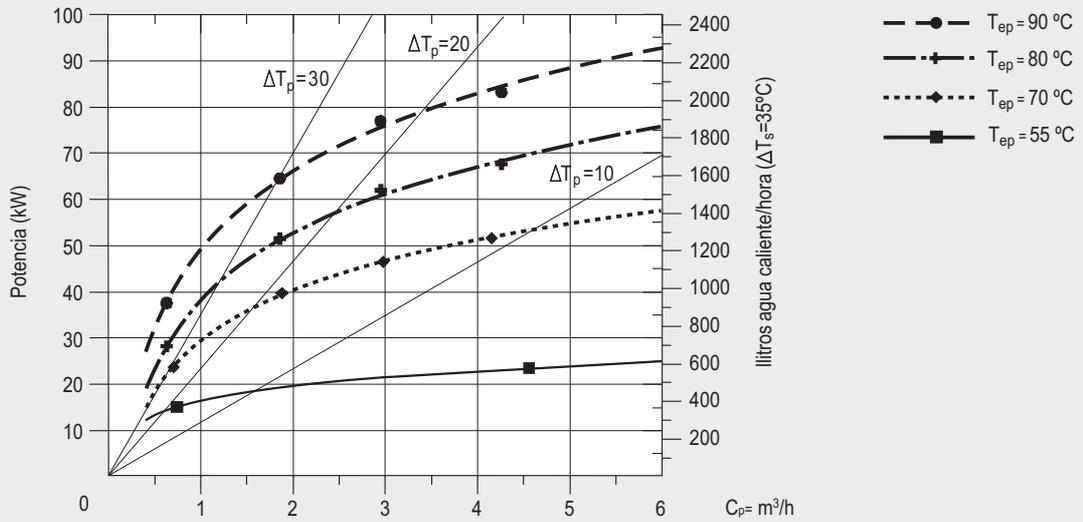
Curvas de potencia para diferentes caudales y temperaturas de circuito primario para producción de agua caliente (circuito cerrado) 10°C → 60°C.
