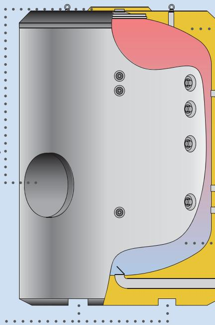
**Isolation PU rigide recouvrant l'ensemble du ballon.**
