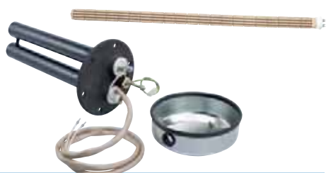
RÉSISTANCES "RCER" STÉATITE SUR BRIDE : Résistance stéatite sur bride pour les modèles CORAL VITRO "SIMPLE PAROI", ACCUMULATION et SERPENTIN. Ensemble plaque acier vitrifié avec fourreaux + résistances céramiques pour montage sur bride latérale.
