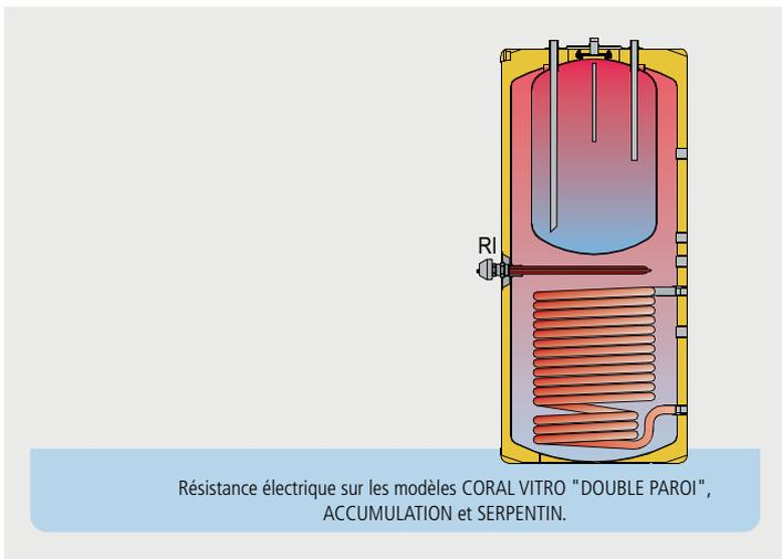
Résistance électrique sur les modèles CORAL VITRO "DOUBLE PAROI", ACCUMULATION et SERPENTIN.
