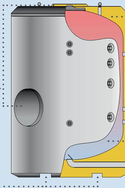
**Isolation PU rigide recouvrant l'ensemble du ballon.**
