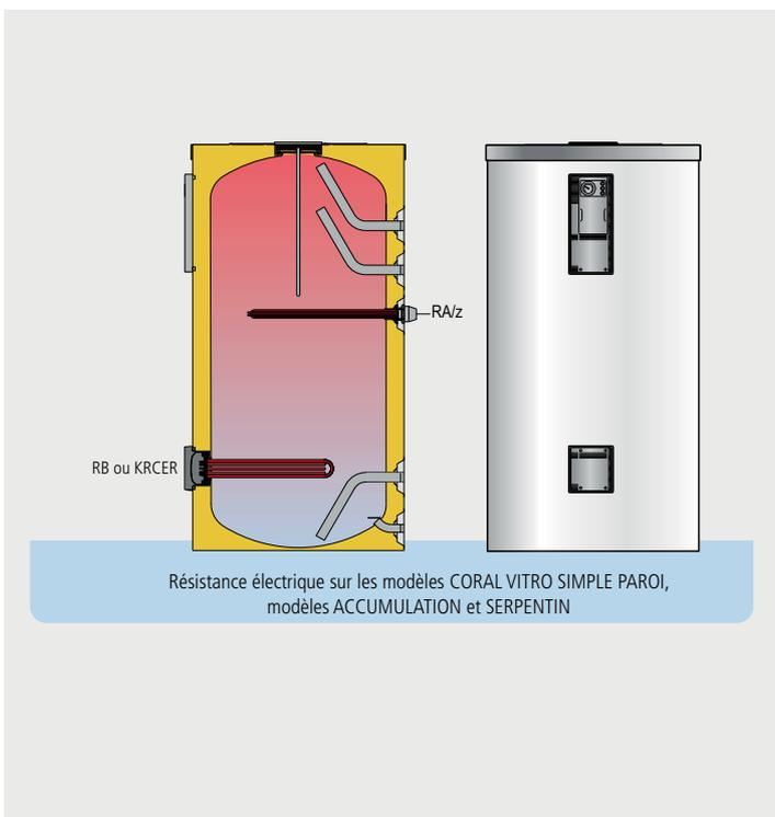
Résistance électrique sur les modèles CORAL VITRO SIMPLE PAROI, modèles ACCUMULATION et SERPENTIN
