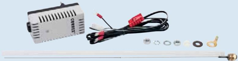
"lapesa correx-up" wartungsfreies Fremdstromanodensystem: Diese Anoden haben keinen Verschleiß und geben automatisch den notwendigen Schutzstrom ab, um den Speicher kathodisch zu schützen. Dieses erfolgt mittels eines an das Stromnetz angeschlossenen Potentiostaten pro Anode.
