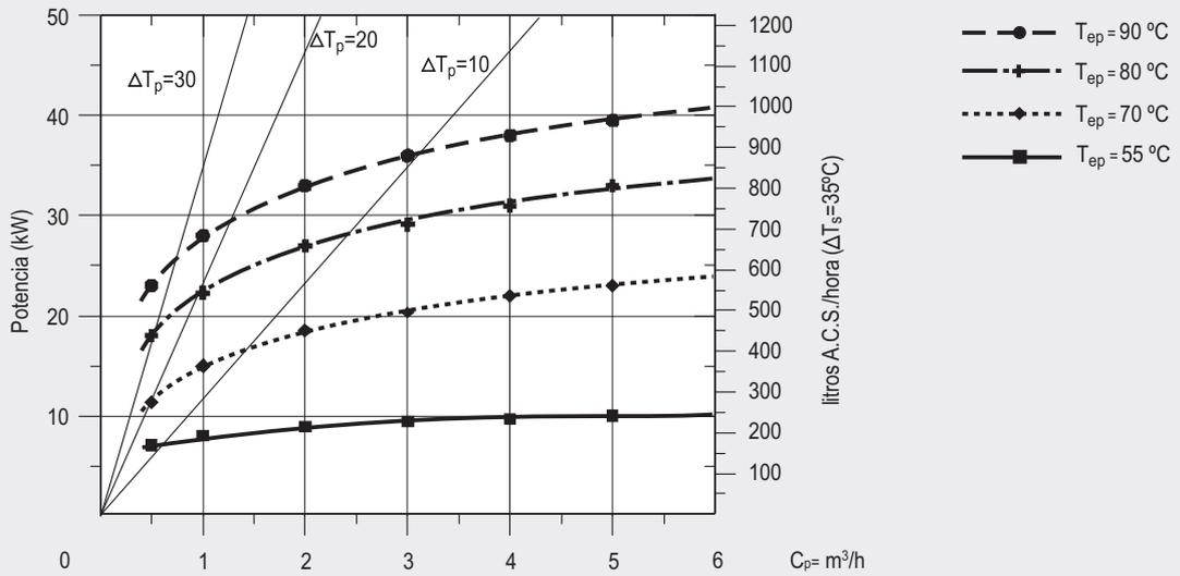
Curvas de potencia para diferentes caudales y temperaturas de circuito primario para producción de A.C.S. 10°C → 60°C.
