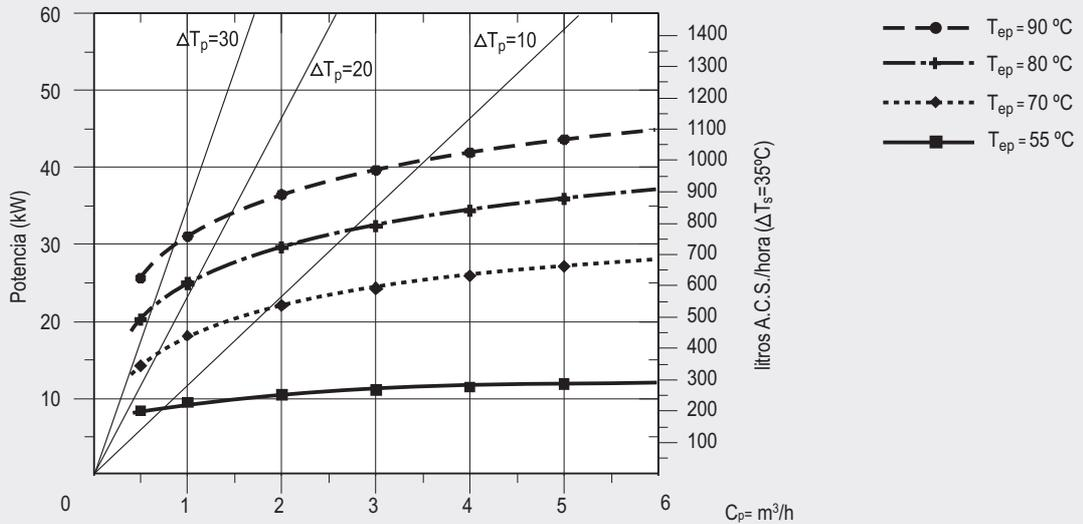
Curvas de potencia para diferentes caudales y temperaturas de circuito primario para producción de A.C.S. 10°C → 60°C.
