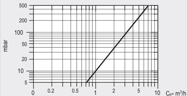
Modelos: Serpentin superior de CV-300-M2 y CV-400-M2
