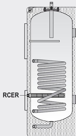
Les modèles CV-110/150-M1 ont préparé un logement pour l'installation d'une résistance électrique et sont fournis avec le panneau de contrôle «ST» (avec thermomètre et thermostat de réglage). Pour l'installation d'une résistance, il est nécessaire de remplacer le panneau fourni avec le réservoir par un panneau de type «TD» ou de type «TPA».
