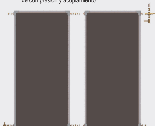
Conexión entre captadores mediante tuercas de compresión y acoplamiento
