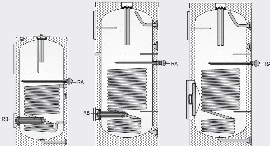
Los depósitos CV-200...1000-M1 y CV-800/1000-M1B se suministran con panel de control tipo "TS" (con termómetro y termostato de regulación). Para la instalación de resistencia eléctrica es necesario sustituir el panel suministrado con el depósito por el panel tipo "TD" (con termostato doble de regulación y seguridad) o tipo "TPA" (con termostato doble y programador horario).
