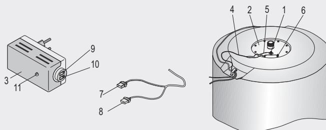
Todos los acumuladores de la serie CORAL-VITRO pueden ser equipados con el sistema de protección catódica permanente LAPESA-Correx up, que es totalmente automático y libre de mantenimiento.
