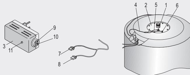
Todos los acumuladores de la serie CORAL-VITRO pueden ser equipados con el sistema de protección catódica permanente LAPESA-Correx up, que es totalmente automático y libre de mantenimiento.
