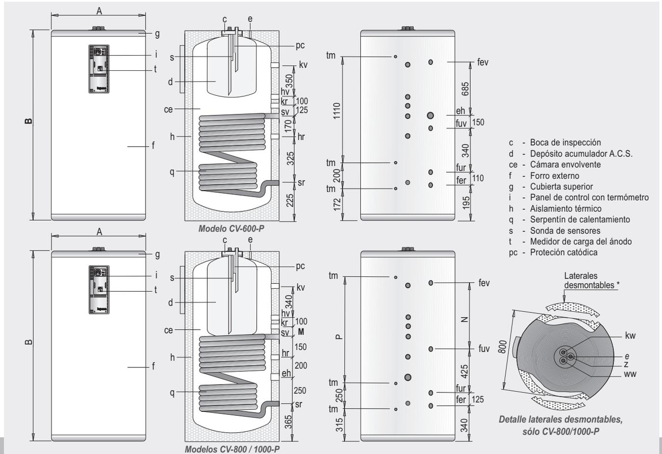
\* Para acceder a los laterales desmontables en el aislante es necesario desmontar el forro del depósito y, para ello las cubiertas y embellecedores.
