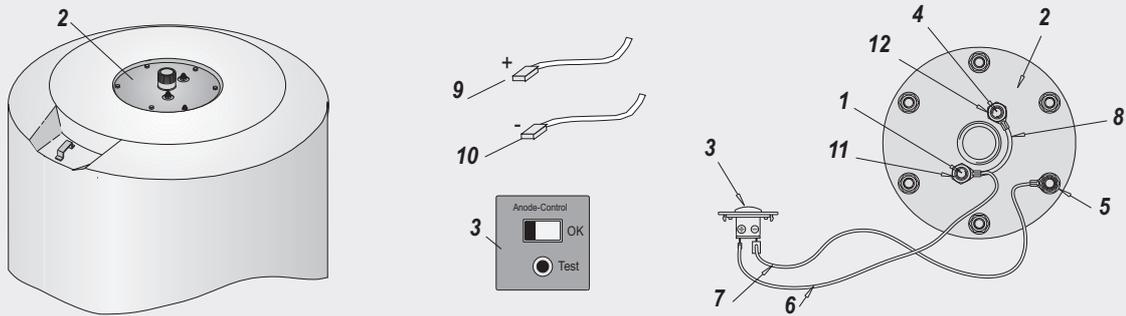
Con el fin de proteger el interior del depósito frente a la corrosión, todos los acumuladores de la serie CORAL-VITRO están equipados con un sistema de protección por medio de ánodos de sacrificio. El equipo de protección catódica se compone de un conjunto de ánodos de Magnesio y medidor de carga, instalado en el depósito. El depósito dispone de las conexiones específicas para este fin.
