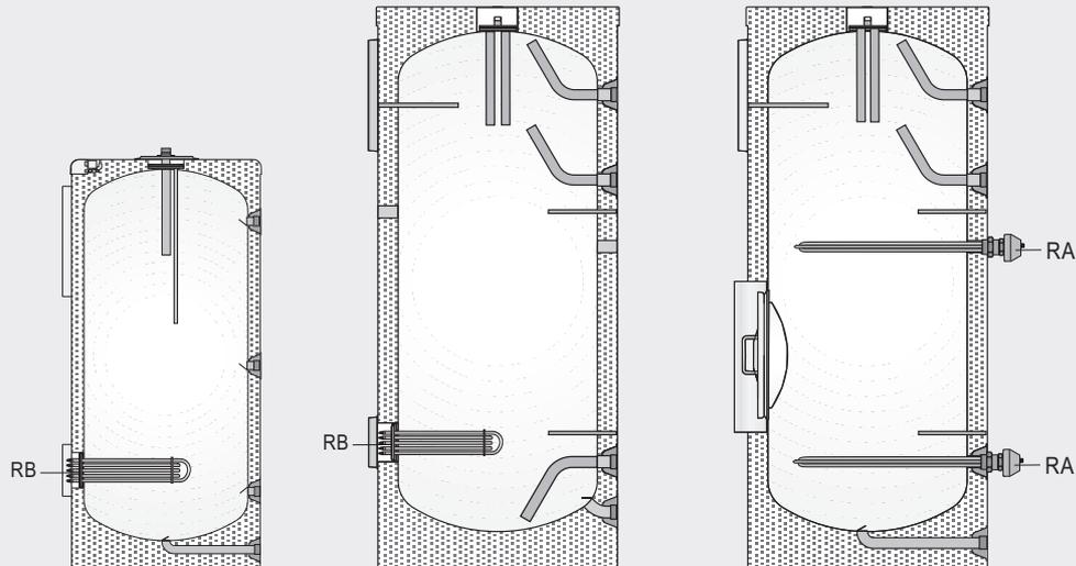
Los depósitos CV-200...1000-R y CV-800/1000-RB se suministran con panel de control tipo "T" (sólo termómetro). Para instalación de resistencia eléctrica es necesario sustituir el panel suministrado con el depósito por el panel tipo "TD" (con termostato doble de regulación y seguridad) o tipo "TPA" (con termostato doble y programador horario).
