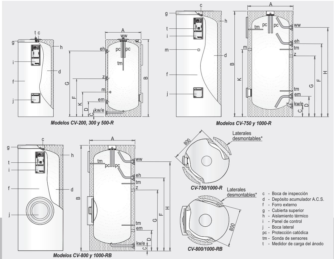
\* Para acceder a los laterales desmontables en el aislante es necesario desmontar el forro del depósito y, para ello las cubiertas y embellecedores.
